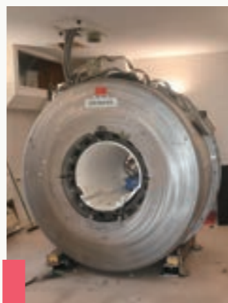
磁石のみを残し解体
